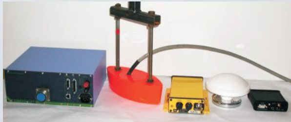
Echolot mit Schwinger (Sende-/Empfängereinheit), DGPS- und RTCM-Empfänger, Antenne für DGPS und RTCM (Radio Technical Commission for Maritime Services)
